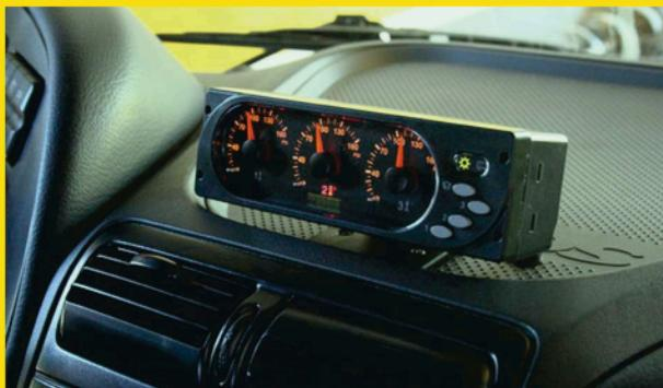
Tablero indicador con manómetros analógicos, el cual se puede embutir en los espacios ya existentes con formato Din.
