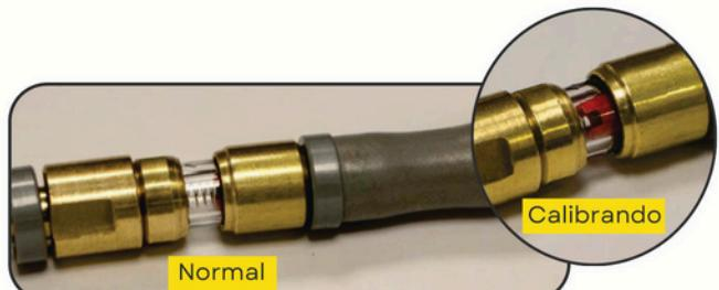
Este visor es instalado entre el rotor y la válvula de inflado, permitiendo identificar de forma rápida cuál es el neumático que se encuentra calibrando y visualiza específicamente cuál es el que se debe reparar. Está disponible para manguera de poliamida y push-look.
